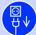
Uit stopcontact halen alvorens te openen Débranchez la fiche d'alimentation secteur avant d'ouvrir
