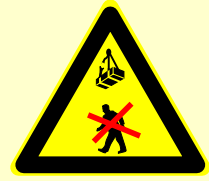
Niet onder de last lopen Ne pas se promener sous la charge
